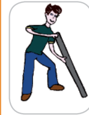
* Bloquer l'extrémité de la poutre pour l'empêcher de glisser
