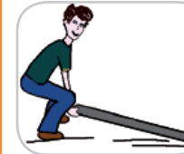
* Bloquer l'extrémité de la poutre pour l'empêcher de glisser
